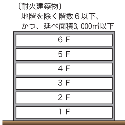
I型を設置できる防火対象物
